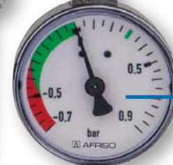
Flexibel drehbare Serviceanzeige für den Anlagenbesitzer. Notwendiger Filterwechsel kann selbst erkannt werden. Ist der Filtereinsatz verschmutzt, steigt das Vakuum an und der Fachhandwerker kann informiert werden.
