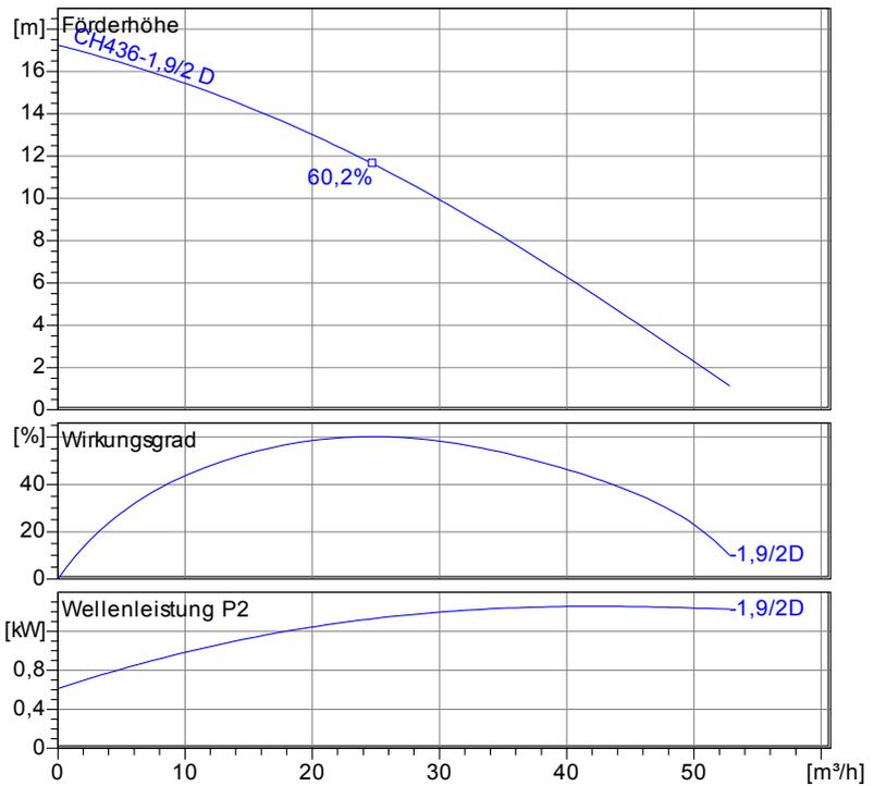
Tauchbetrieb mit automatischem Kupplungssystem -1,9kW
