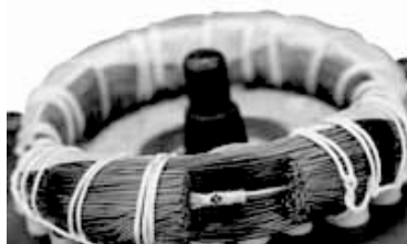
Abb. 44 PTC-Sensor - eingebaut in die Wicklungen
