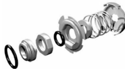
Abb. 14 Explosionszeichnung einer Gleitringdichtung
