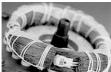
Abb. 46 Thermoschalter - eingebaut in die Wicklungen
