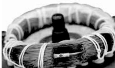
Abb. 44 PTC-Sensor - eingebaut in die Wicklungen
