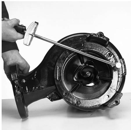
8. Bringen Sie die Pumpe in eine vertikale Stellung. Überprüfen, ob sich das Laufrad frei drehen kann.
