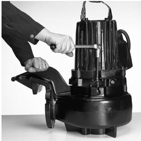
2. Schrauben Sie die Laufradschraube heraus. Verwenden Sie ggf. die Stange.
