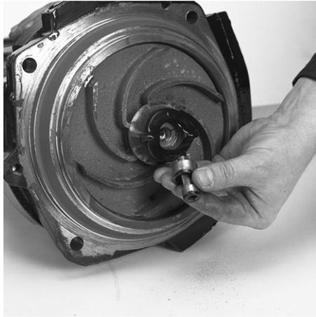
4. Setzen Sie den Laufradabzieher an und ziehen Sie Laufrad und Schneiderad ab. Positionieren Sie einen Schutz zwischen Schraubenkopf und Laufradabzieher.
