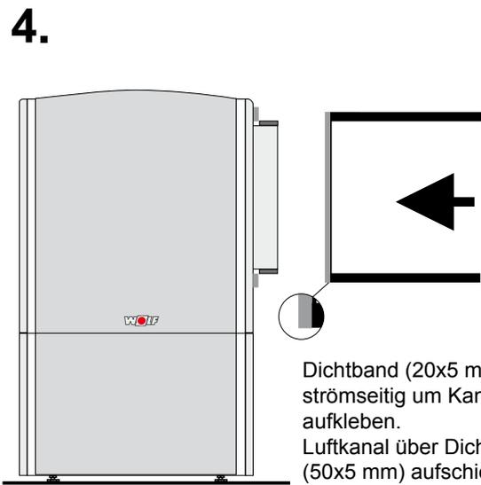
Dichtband (20x5 mm) strömseitig um Kanal aufkleben. Luftkanal über Dichtband (50x5 mm) aufschieben und an Dichtband (20x5 mm) zur Wärmepumpe leicht anpressen
