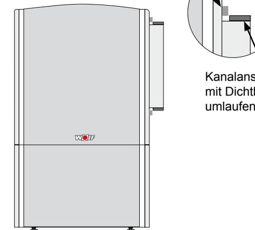
Kanalanschlussrahmen mit Dichtband (50x5 mm) umlaufend bekleben
