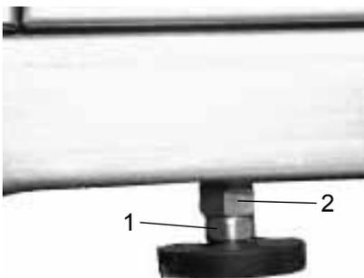
Über die vier Stellschrauben Gerät waagrecht ausrichten und anschliessend die Kontermutter festziehen.
