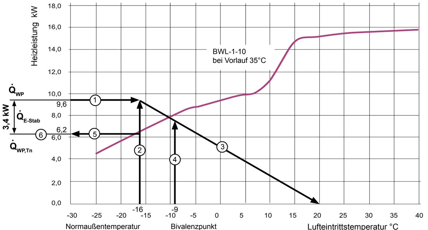
Gemäß dem Diagramm entspricht die theoretische Heizleistung im Normauslegungspunkt ca. 6,2 kW. Da ein Heizstab mit 6 kW eingebaut ist, steht eine maximale Heizleistung von 12,2 kW bei -16°C Außentemperatur zur Verfügung.
