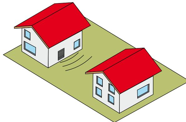
Q=8: Wärmepumpe oder Luftein-/Luftauslass (bei Innenaufstellung) an einer Hauswand bei einspringender Fassadenecke
