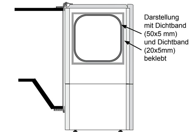
Darstellung mit Dichtband (50x5 mm) und Dichtband (20x5mm) beklebt
