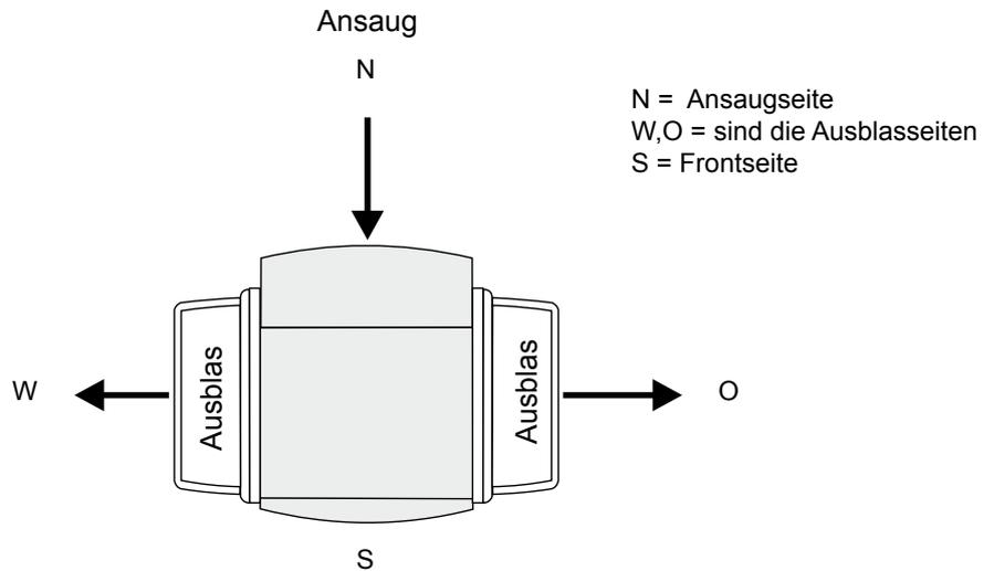
Nach DIN EN 12102 wird der Schalleistungspegel von Wärmepumpen ermittelt. Er dient der Vergleichbarkeit, unabhängig von Umgebung, Richtung und Abstand.
