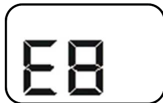
Abb. 13: Anzeige Fehlermeldung E8 (Motorfehler)
