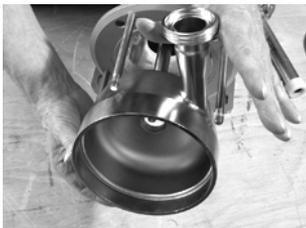
**Abb. 25** Druckgehäuse, Welle
