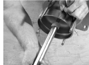
**Abb. 29** Feststehender Ring der Gleitringdichtung, Druckgehäuse
