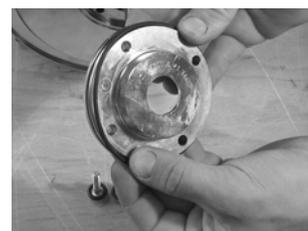
Abb. 53 Dichtungsdeckel
