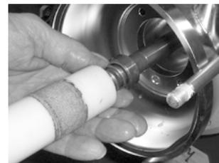
Abb. 41 Rotierender Gleitring der Gleitringdichtung
