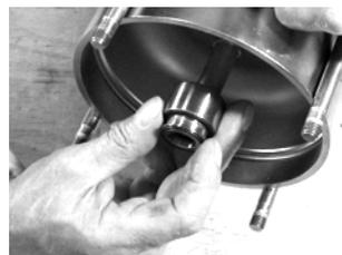
**Abb. 30** Rotierender Gleitring der Gleitringdichtung
