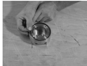
**Abb. 32** Dichtungspatrone mit O-Ring
