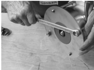
Abb. 71 Laufradmutter-Montagevorrichtung
