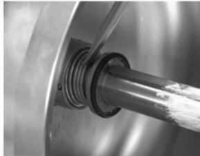
**Abb. 58** Feder der Gleitringdichtung
