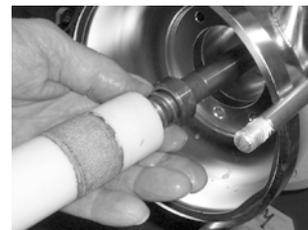
Abb. 51 Gleitring der Gleitringdichtung
