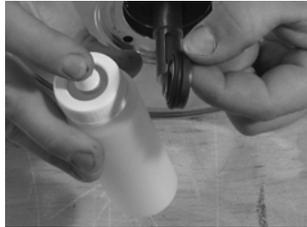
Abb. 38 Feststehender Ring der Gleitringdichtung
