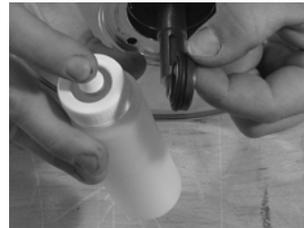
**Abb. 27** Feststehender Ring der Gleitringdichtung
