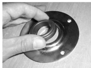
Abb. 52 Gegenring der Gleitringdichtung
