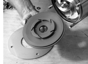
Abb. 70 Laufradmutter-Montagevorrichtung
