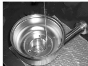
**Abb. 34** Druckgehäuse
