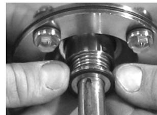
**Abb. 31** Dichtungsscheibe mit O-ring
