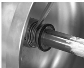
Abb. 63 Feder der Gleitringdichtung
