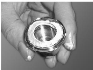
Abb. 72 Sicherungsscheiben in Laufradmutter
