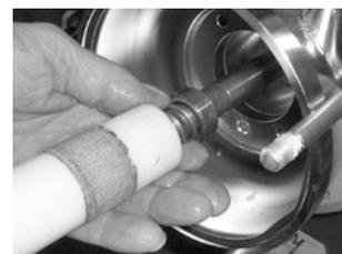
Abb. 56 Gleitring der Gleitringdichtung
