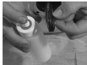
**Abb. 32** Feststehender Ring der Gleitringdichtung
