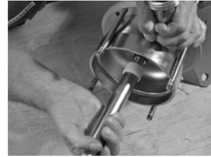
**Abb. 34** Feststehender Ring der Gleitringdichtung, Druckgehäuse
