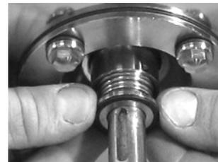
**Abb. 36** Dichtungsscheibe mit O-ring
