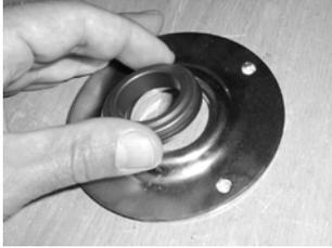
Abb. 57 Gegenring der Gleitringdichtung
