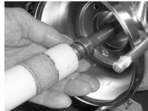
**Abb. 46** Rotierender Gleitring der Gleitringdichtung
