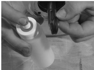
Abb. 43 Feststehender Ring der Gleitringdichtung
