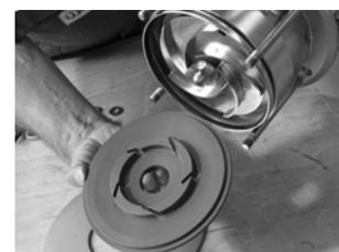
Abb. 75 Laufradmutter-Montagevorrichtung
