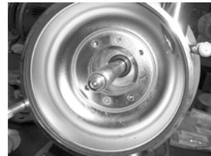
Abb. 44 Feststehender Ring der Gleitringdichtung
