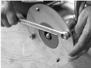
**Abb. 76** Laufradmutter-Montagevorrichtung
