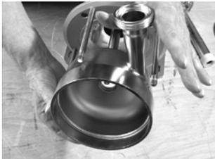
**Abb. 30** Druckgehäuse, Welle
