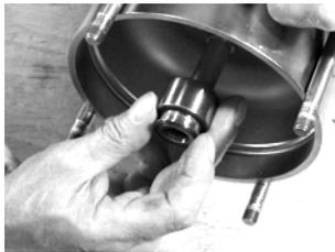
**Abb. 35** Rotierender Gleitring der Gleitringdichtung
