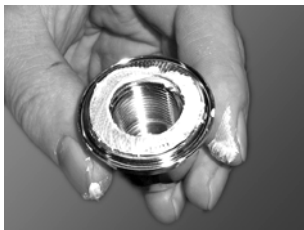
Abb. 40 Sicherungsscheiben in Laufradmutter
