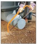
Die geforderte Anschlussnennweite von DN 150 bis DN 400 kann durch einfaches Absägen der Anschlussstutzen erreicht werden. Bei Bedarf sind weitere seitliche Anschlüsse unter Verwendung der KESSEL-Rohrdurchführungen leicht möglich.
