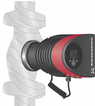
Abb. 18 Dämmen des Pumpengehäuses und der Rohrleitungen
