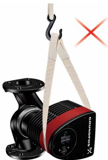
Abb. 10 Falsches Anheben der Pumpe
