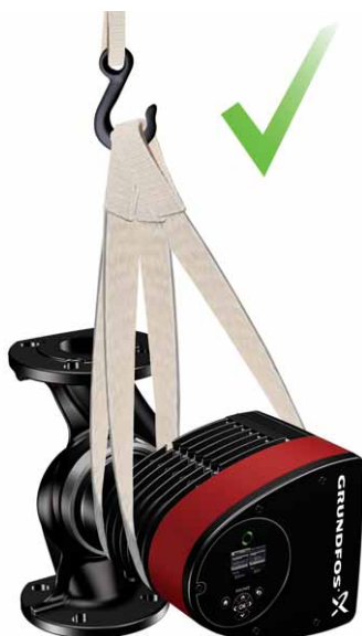
Abb. 9 Korrektes Anheben der Pumpe
