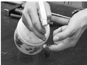
Abb. 60 Stationär Teil Gleitringdichtung
