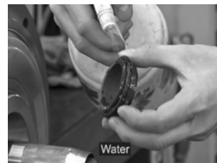
Abb. 53 Stationärer Teil der Gleitringdichtung
