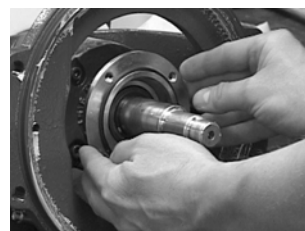
Abb. 63 Dichtungsdeckel auf Welle
