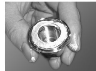
Abb. 82 Nord-Lock Scheiben in Laufradmutter
