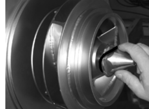
Abb. 84 Runddichtring für Laufradmutter
