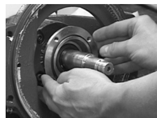
Abb. 29 Dichtungsdeckel auf Welle
