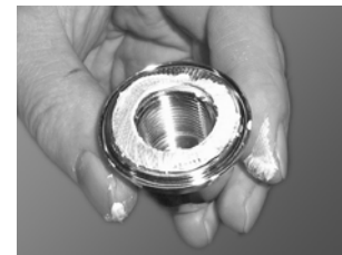
Abb. 48 Nord-Lock Scheiben in Laufradmutter
