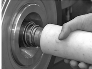
Abb. 22 Rotierender Teil der Gleitringdichtung
