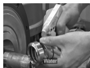
Abb. 21 Rotierender Teil der Gleitringdichtung
