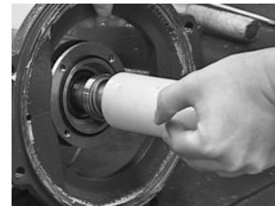
Abb. 31 Rotierender Teil Gleitringdichtung
