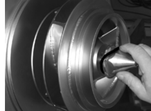
Abb. 50 Runddichtring für Laufradmutter
