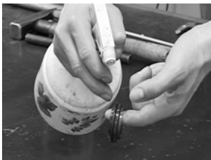
Abb. 26 Stationär Teil Gleitringdichtung
