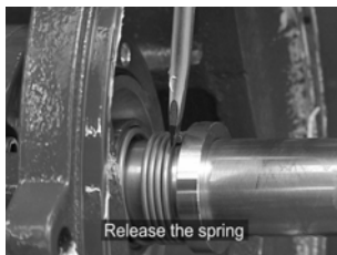
Abb. 34 Feder der Gleitringdichtung
