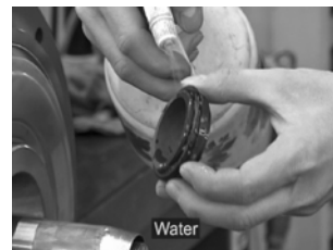
Abb. 19 Stationärer Teil der Gleitringdichtung
