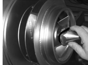
**Abb. 26** Runddichtring für Laufradmutter
