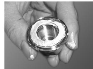
Abb. 24 Nord-Lock Scheiben in Laufradmutter
