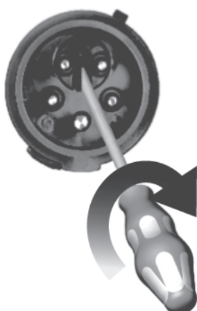
Abb. 14 Ändern der Phasenfolge bei einer dreiphasigen Steuerung mit Hilfe eines Phasenwenders
