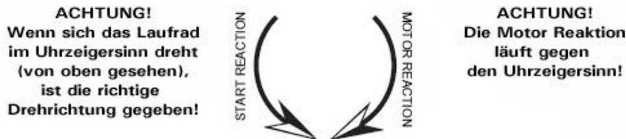
Bei großen Pumpen kann man die Drehrichtung auch erkennen, indem man durch den Druckstutzen in die Pumpenkammer schaut. Hier sieht man das Laufrad und kann nach einem kurzen einschalteten, beim Auslaufen des Laufrades die Drehrichtung kontrollieren.
