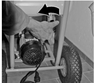
4. Vorratsbehälter befüllen und Kugelhahn öffnen
