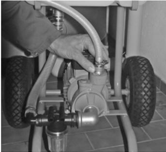
1. Druckschlauch am Pumpenausgang anschließen
