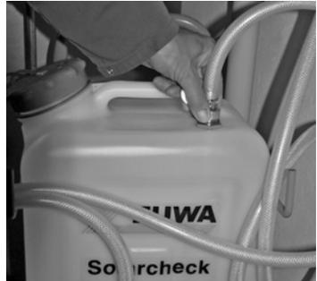
2. Rücklaufschlauch befestigen
