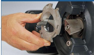
Das patentierte Schneidsystem aus gehärtetem nichtrostenden Stahl besteht aus einem stationären Schneidring und einem rotierenden Schneidkopf mit einem dahinter angeordneten halboffenen Laufrad aus Grauguss.
