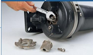
Der schnell und einfach von außen nachstellbare Axialspalt sorgt für einen stets gleichbleibenden Wirkungsgrad.
