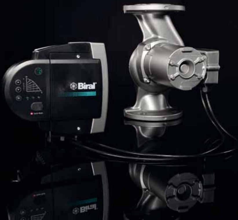
Bei der ModuA... GREEN für Kältemedien wird der Frequenzumrichter abgesetzt montiert. Dies verhindert die Kondensatbildung auf der Elektronik und sorgt für einen verlässlichen Betrieb und eine lange Lebensdauer.
