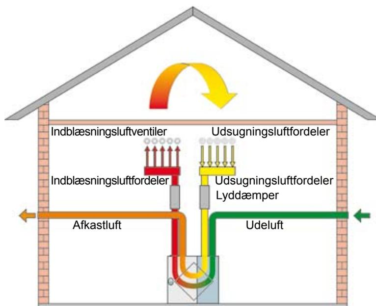
Til montering af udeluft- og afkastluftledninger fra og til Comfort-boligventilationsanlægget CWL.
