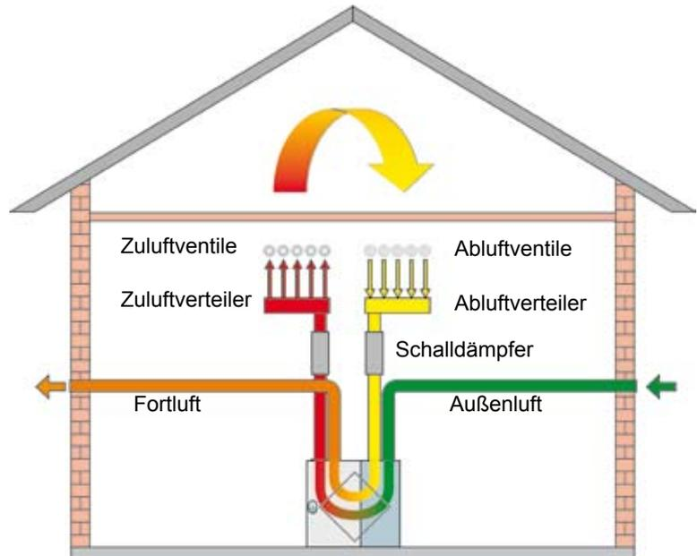
Zur Erstellung der Außenluft- und Fortluftleitungen vom und zum Comfort-Wohnungs-Lüftungsggerät CWL.
