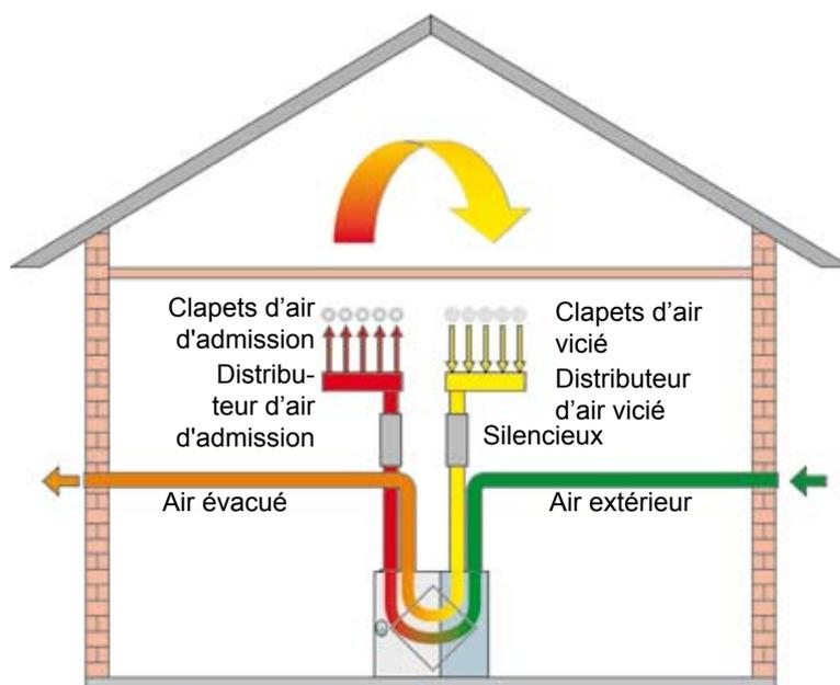
Pour installer les conduites d'air extérieur et d'air évacué à partir de et vers l'Aération de Confort dans les Habitations ACH.
