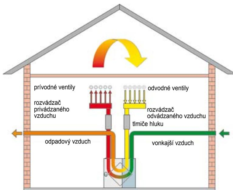
Zapojenie prívodného a odvodného potrubia na vonkajší a odpadový vzduch do vetracej jednotky CWL a vzduchu vypúšťaného z vetracej jednotky CWL. Zapojenie prívodného a odvodného potrubia z jednotky CWL k rozvádzačom vzduchu.
