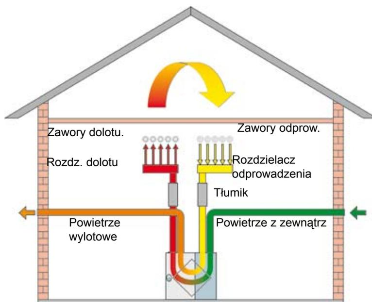
Do prowadzenia powietrza wylotowego i powietrza z zewnątrz do i z rekuperatora CWL
