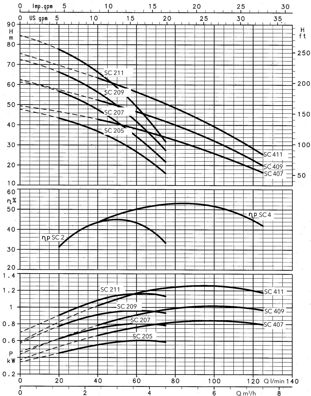
Die angegebenen Leistungen gelten für Flüssigkeiten mit einer Dichte von  $\rho = 1,0 \text{ kg/dm}^3$  und einer kinematischen Viskosität von  $\gamma = 1 \text{ mm}^2/\text{sec}$ .
