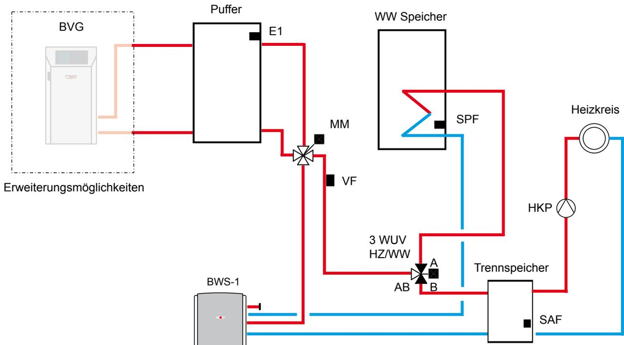
Bei BWS-1 ist 3-Wege-Umschaltventil Heizung/Warmwasser und Zubringer-/Heizkreispumpe integriert
