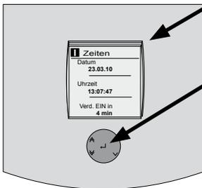
Beleuchtetes LC-Display zur Anzeige von Informationen wie Betriebszustände, Messwerte und Einstellungen der Wärmepumpe.
