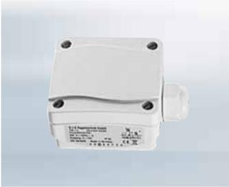
Der Schalterpunkt des Taupunktwächters kann über ein Potentiometer zwischen 80 und 100 % rF eingestellt werden (Werkseinstellung 90 % rF). Übersteigt die Feuchtigkeit am Taupunktwächter den eingestellten Wert, wird die passive Kühlung unterbrochen und die Vorlaufsollltemperatur für passive Kühlung um 1K angehoben. Wenn der Taupunktwächter wieder schließt, wird die Kühlung fortgesetzt.
