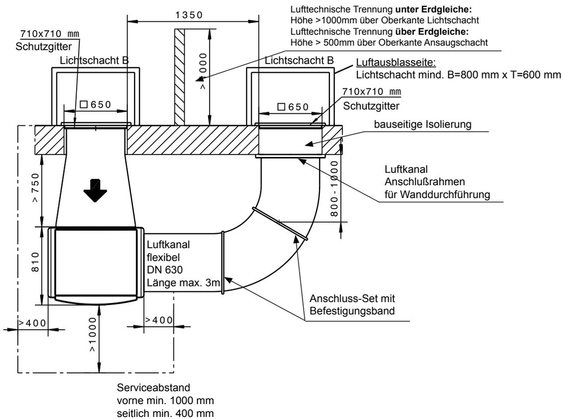
BWL-1-08/10/12/14 Eck-Aufstellung unter Erdgleiche mit flexiblem Luftkanal, Luftansaug reduziert /56
