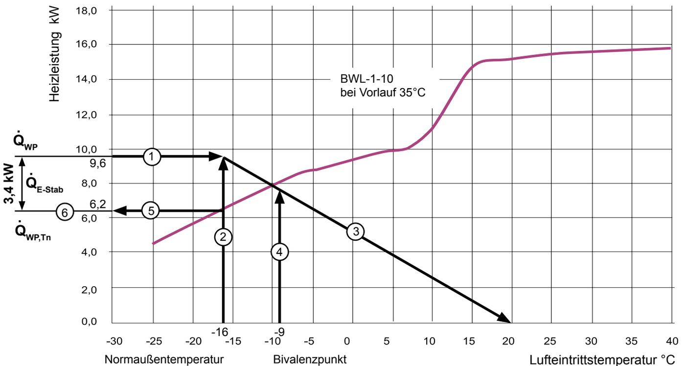
Gemäß dem Diagramm entspricht die theoretische Heizleistung im Normauslegungspunkt ca. 6,2 kW. Da ein Heizstab mit 6 kW eingebaut ist, steht eine maximale Heizleistung von 12,2 kW bei -16°C Außentemperatur zur Verfügung.
