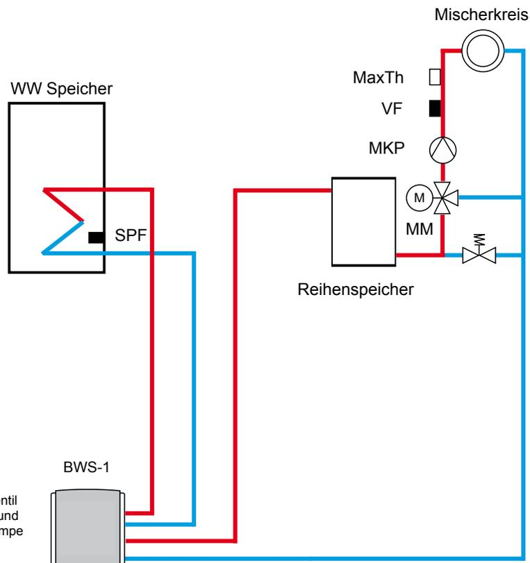
Bei BWS-1 ist 3-Wege-Umschaltventil Heizung/Warmwasser und Zubringer-/Heizkreispumpe integriert
