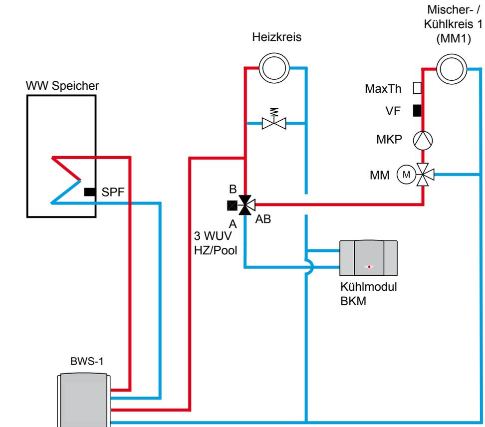
Bei BWS-1 ist 3-Wege-Umschaltventil Heizung/Warmwasser und Zubringer-/Heizkreispumpe integriert
