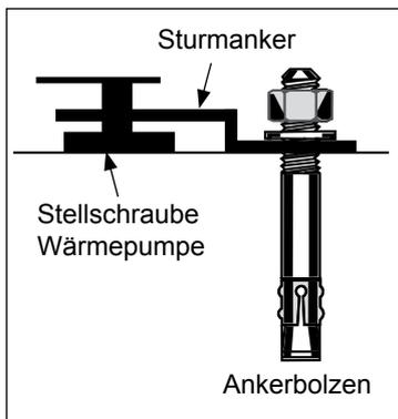
Die Regeln der Bautechnik sind zu beachten. Ausreichende Standsicherheit in den Windlastzonen 1 und 2 nach DIN 1055-4. Bei Aufstellorten außerhalb der genannten Windzonen oder in Küstennähe bis 5 km können zusätzliche Maßnahmen bzw. ein Nachweis erforderlich sein. Dies kann z.B. auch bei Aufstellung zwischen Gebäudeteilen mit Windkanalwirkung zutreffen.
