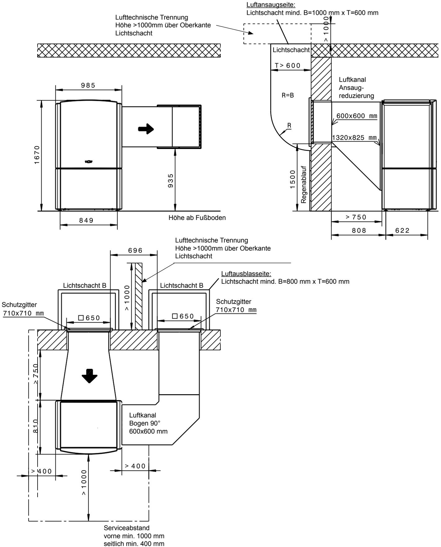
BWL-1-08/10/12/14 Linear-Aufstellung unter Erdgleiche lang, Luftansaug reduziert /54
