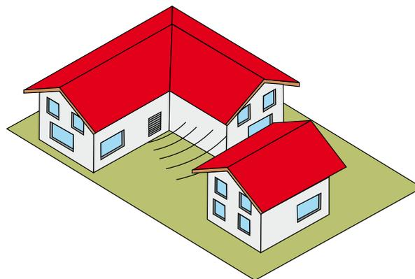
Nach DIN EN 12102 wird der Schallleistungspegel von Wärmepumpen ermittelt. Er dient der Vergleichbarkeit, unabhängig von Umgebung, Richtung und Abstand.
