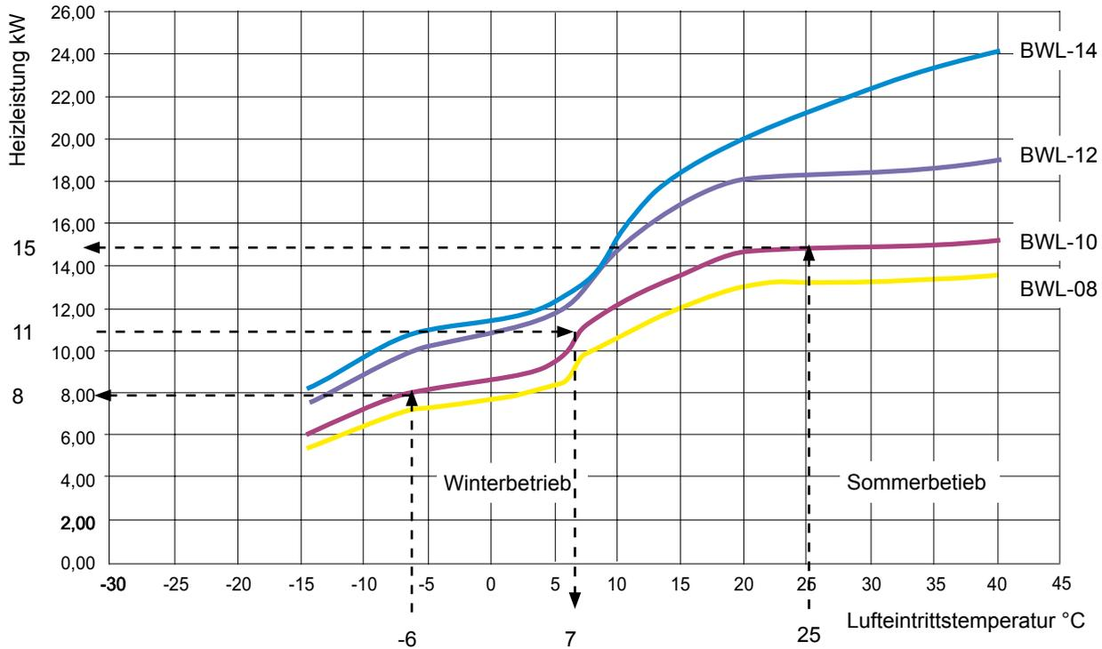
Mit der geschätzten Luftertrittstemperatur (Sommer) von 25°C in das Diagramm → ca. 15 kW Heizleistung
