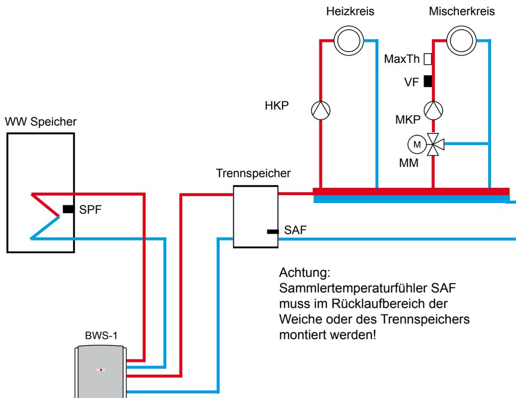
Bei BWS-1 ist 3-Wege-Umschaltventil Heizung/Warmwasser und Zubringer-/Heizkreispumpe integriert
