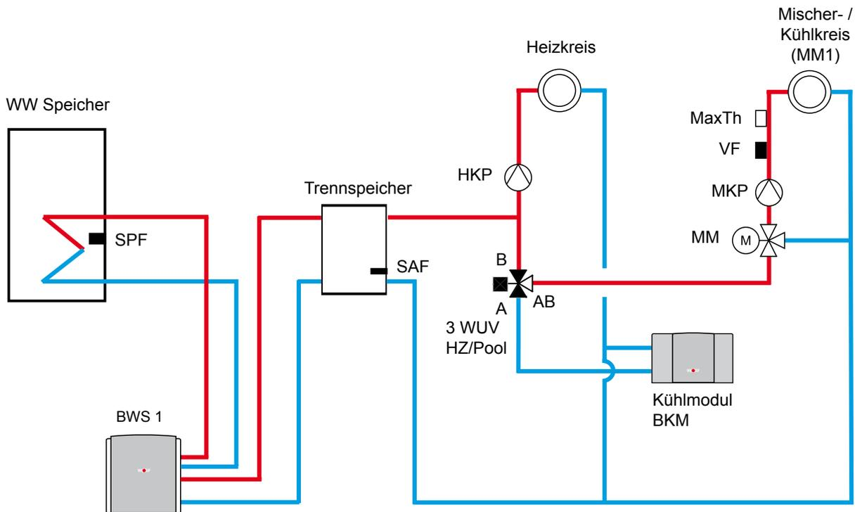
Bei BWS-1 ist 3-Wege-Umschaltventil Heizung/Warmwasser und Zubringer-/Heizkreispumpe integriert
