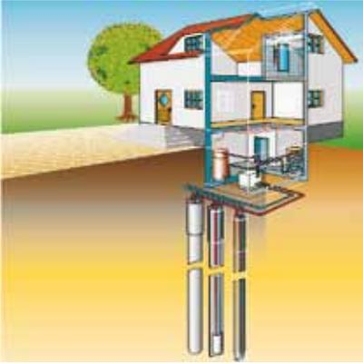
Erdsonden können bis zu einer Bohrungstiefe von 100 m ohne bergrechtliche Genehmigung erstellt werden. Bis zu dieser Tiefe besteht jedoch eine Genehmigungspflicht, die mit der zuständigen Wasserbehörde abzustimmen ist.
