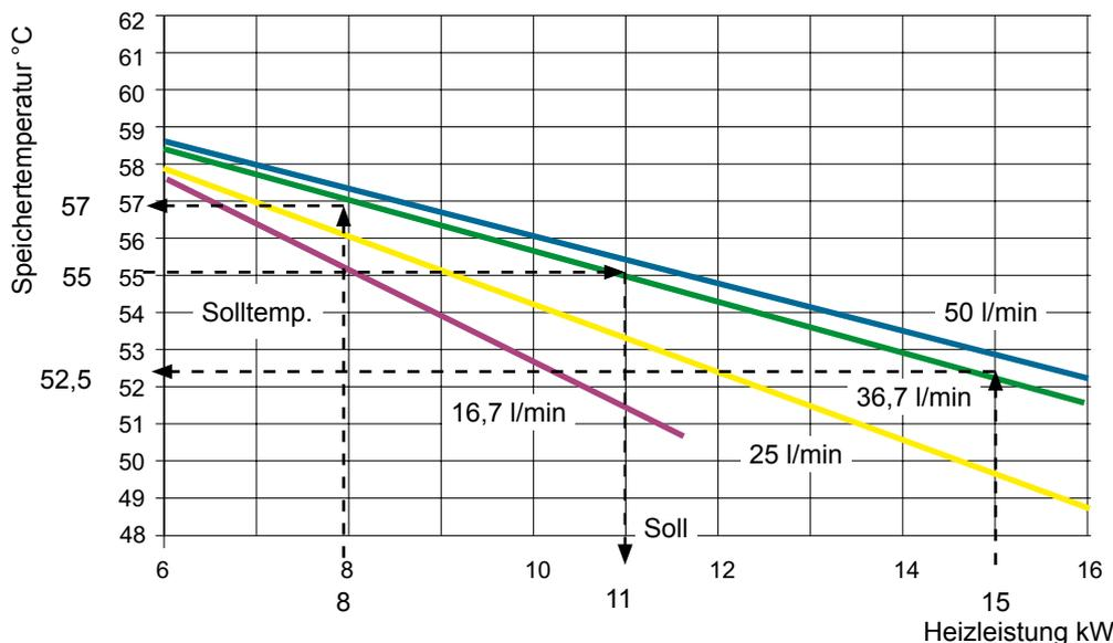
Mit der ermittelten Heizleistung kann im Diagramm des CEW-1-200 die maximal mögliche Speichertemperatur anhand des Durchflusses (ca. 37 l/min) ermittelt werden.
