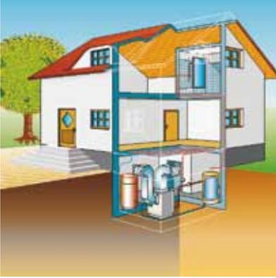
Luft-/Wasser Wärmepumpen zur Aufstellung in Gebäuden nach heutigem Baustandard sind ohne Einschränkung einsetzbar. In Verbindung mit dem integrierten Heizeinsatz können diese monoenergetisch, also als einziger Wärmeerzeuger, betrieben werden.
