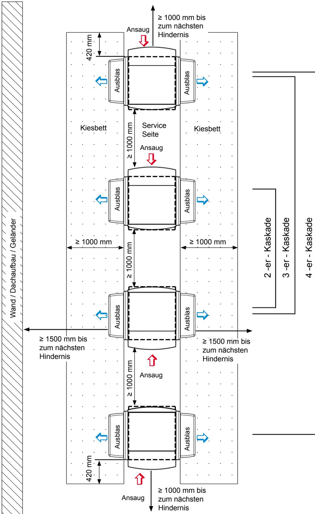
**Hinweis:** -- Im Falle einer 5-er – Kaskade muss die Luftansaugseite des fünften Gerätes (an der linken oder rechten Seite) nach Außen positioniert werden (wie bei der 4-er – Kaskade).
