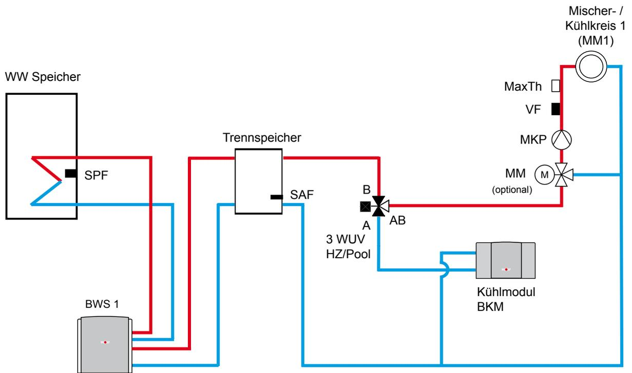
Bei BWS-1 ist 3-Wege-Umschaltventil Heizung/Warmwasser und Zubringer-/Heizkreispumpe integriert
