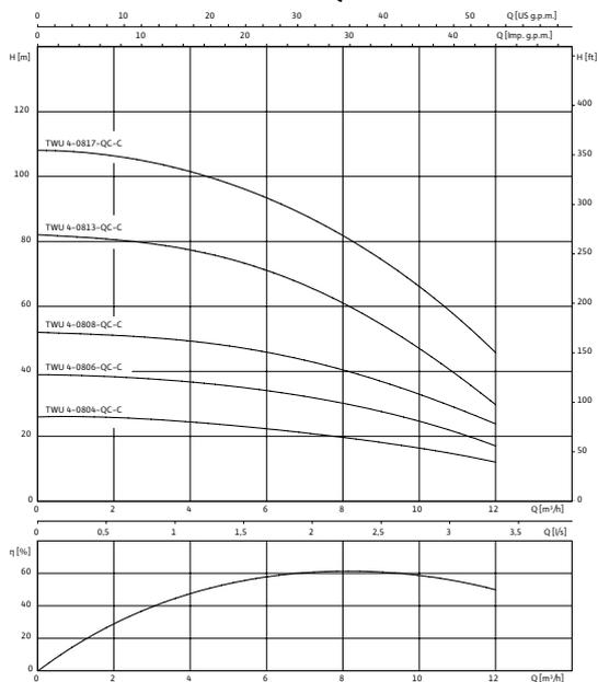
1~230 V bzw. 3~400 V, 50 Hz,  $\rho = 1 \text{ kg/dm}^3$ ,  $\nu = 1 \times 10^{-6} \text{ m}^2/\text{s}$ , ISO 9906 Anhang A,  $\eta$  = Pumpenwirkungsgrad
