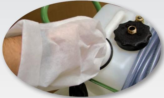
Verwenden Sie bei sehr stark verschmutzter Wärmeträgerflüssigkeit oder verschlammtem Heizungswasser die neuen Einweg-Filterbeutel. Sie ergänzen den Filter am Pumpeneingang der ZUWA-Spülstationen und verhindern, dass das Filtersieb verstopft.
