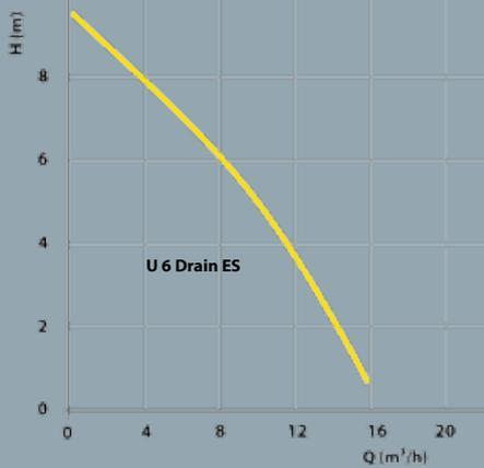
Das Drainageset von JUNG PUMPEN wird als steckerfertiges Set mit einer Drainagepumpe U 6 Drain ES geliefert. Das Set beinhaltet sinnvolle Komponenten, welche die Installation und Inbetriebnahme in der Drainageanwendung kinderleicht machen.
