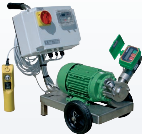
NIROSTAR 2000-C mit Frequenzumrichter und Fernbedienung
